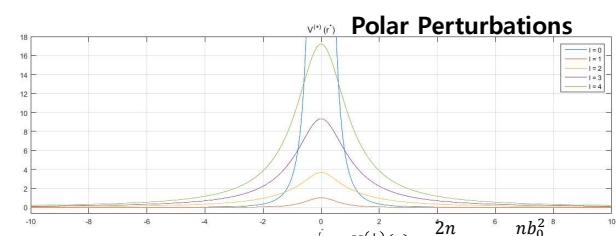
$$V^{(+)}(r) = \frac{2n}{r^2} - \frac{nb_0^2}{r^2(nr^2+b_0^2)} + \frac{b_0^4}{r^4(nr^2+b_0^2)} + \frac{2n(r^2-b_0^2)(nr^2-3b_0^2)}{r^2(nr^2+b_0^2)^2}$$
